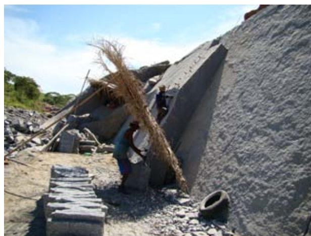
Figura 7.10 – Método manual de extração de rocha para cantaria, Santo Antônio de Pádua, RJ
