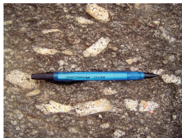
Figura 3.27 – Granitóide porfírico da Suíte Desengano. Pórfiros de plagioclásio de até 5 cm de comprimento
