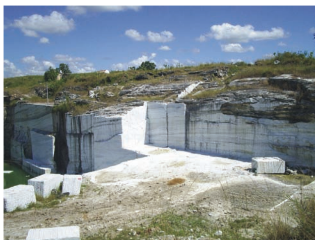
Figura 7.9 – Extração de mármore para corte e polimento em chapas, município de Italva, RJ
